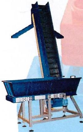
Sistemi di carico con nastri metallici dotati di palettatura per carico di materiali molto pesanti. Vasche di carico di grandi dimensioni.
